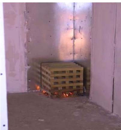
Foco de incêndio padronizado constituído de engradado de madeira seca
